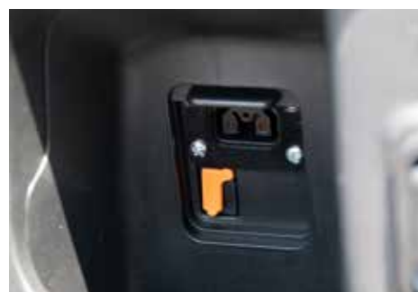
Het laadpunt en USB-poort links onder het stuur
