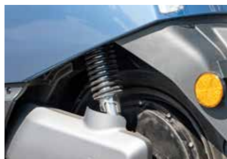
De veervoorspanning aan de achterzijde is in te stellen
